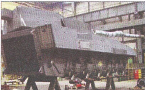
Отсек в задней части корпуса машины
