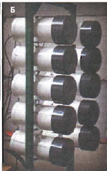
Оборудование установки для дистанционного обнаружения ядерных материалов PITAS: линейный ускоритель электронов (А), детекторы ионизирующего излучения (Б)
