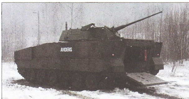
Боевая машина «Андерс» в варианте БМП (с башней Hifist-30P, включающей 30-мм автоматическую пушку)
