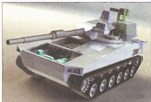
Размещение силовой установки в передней части корпуса БМТВ
