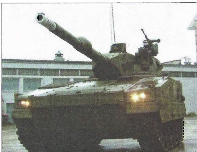
БМТВ LC-08 «Андерс» с гладкоствольным 120-мм орудием RUAG CGT швейцарского производства
