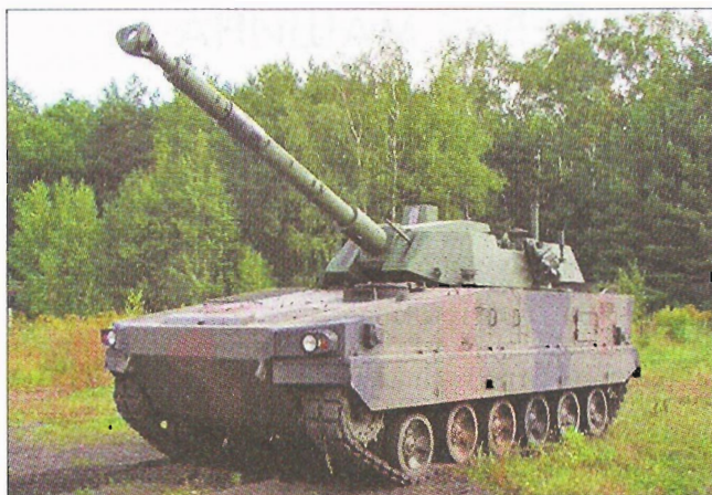
БМ LC-08 «Андерс» с башенной частью СТ-СУ (105-мм орудие) бельгийской компании СМІ
